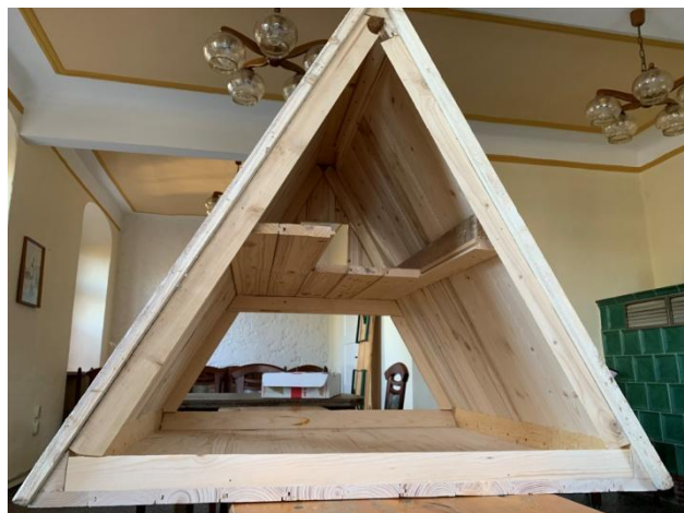
Abbildung 2: Der geöffnete Kasten mit Zwischenboden, aber noch fehlender Reinigungsklappe (hinten) (MARIO SCHOLZ)
